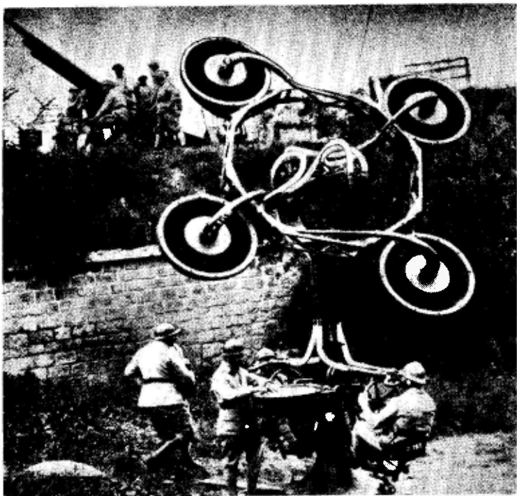
Una de las "orejas mecánicas" del Ejército francés, para localizar aeroplanos enemigos.
